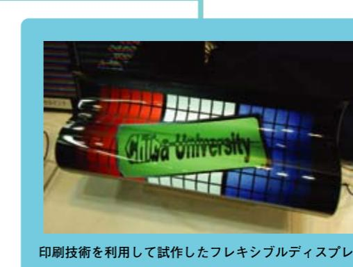
印刷技術を利用して試作したフレキシブルディスプレイ
