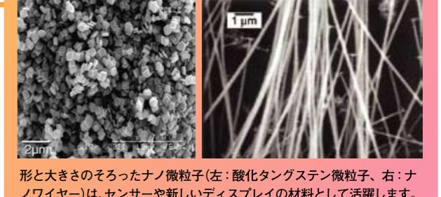
形と大きさのそろったナノ微粒子(左:酸化タンゲステン微粒子、右:ナノワイヤー)は、センサーや新しいディスプレイの材料として活躍します。
